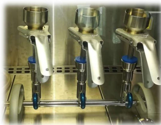
Figure 3: Rampe de filtration à trois postes avec entonnoir de 100 ml.
