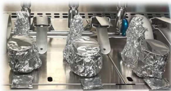
Figure3: La rampe de filtration
