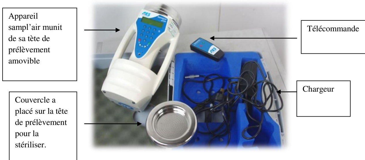
Figure 1: L'appareil SAMPL'AIR LITE de Biomerieux .
